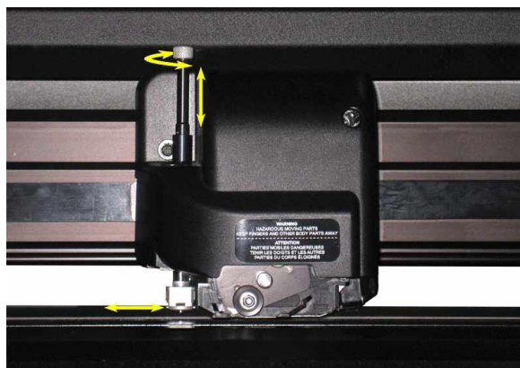
ABB 1-31 EINFÜHREN DES TANGENTIALEN MESSERHALTERS
